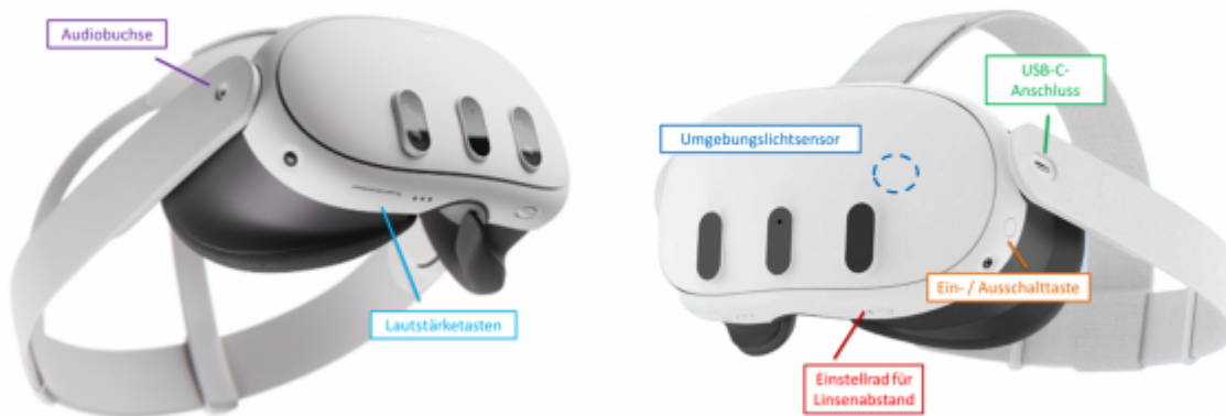
Abbildung 1: Aufbau des Headsets; eigene Darstellung verändert von links externe Verlinkung (10.10.2024) und rechts externe Verlinkung (10.10.2024)
